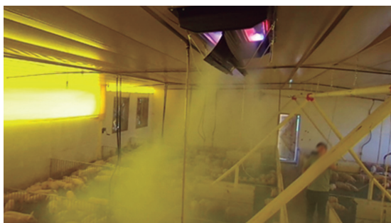
Figura 11: Evaluación de la dirección del aire con humo.
